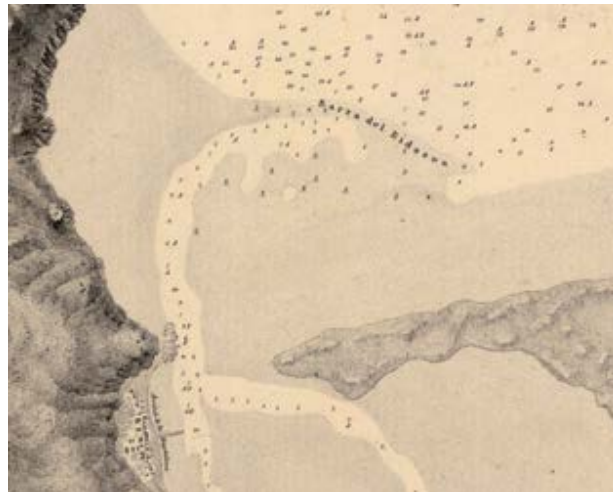
La barra en 1826. Con un único canal imposible de atravesar en bajamar y tremendamente peligroso en media marea. (Hidrografía de la Marina francesa).
